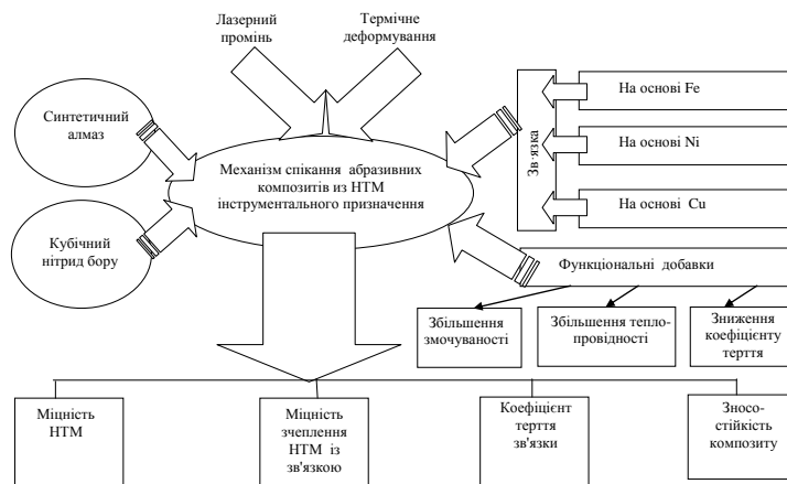
Рис.1. Схема механізму лазерного спікання функціональних композитів із НТМ інструментального призначення з заданими властивостями
