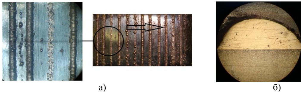
Рис. 8. Загальний вигляд дослідного зразку композиту Бр010. Режимі спікання: P=300 Вт, v = 0,1 - 0,5 м/хв., d_n = 3 мм. Обробка по стрілці. Збільшення – \times 32 . Шліфи композиту Бр010: а – v = 0,2 м/хв.; d_n = 3 мм; P = 300 Вт; б – v = 0,1 м/хв.; d_n = 3 мм; P = 500 Вт. Витрати аргону 7 л/хв. Збільшення - \times 100
